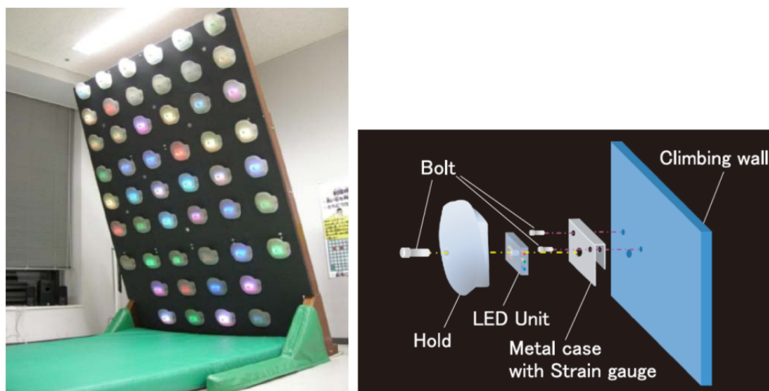
図 2 : センサが埋め込まれたセンサ遊具とセンサ部の構造
