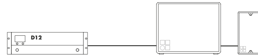
D12 amplifier in Mix TOP/SUB mode for E4, E5, E6, E8, E12 or E12-D and E12X-SUB, E15X-SUB or B4-SUB
