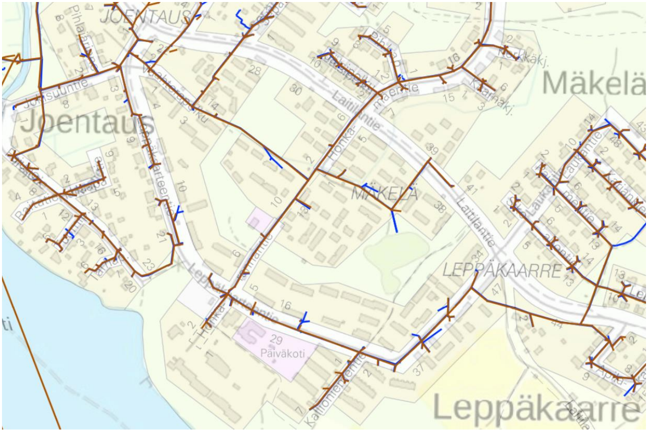
Kuva 9. Kuopion Veden vesi- ja jätevesiverkko (vesijohto sininen, jätevesi ruskea).
