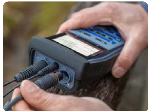
Com interface mini USB-B à prova d'água para transferência de dados atualizada.
