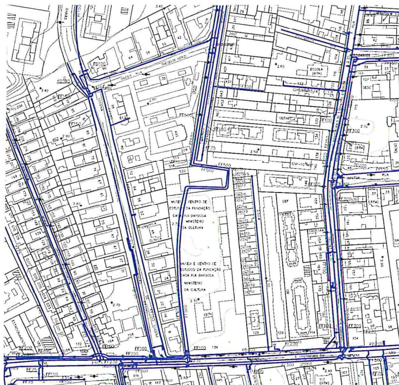
Figura 02 – Tubulações DN500 que atravessam o terreno da Fundação Casa Rui Barbosa
