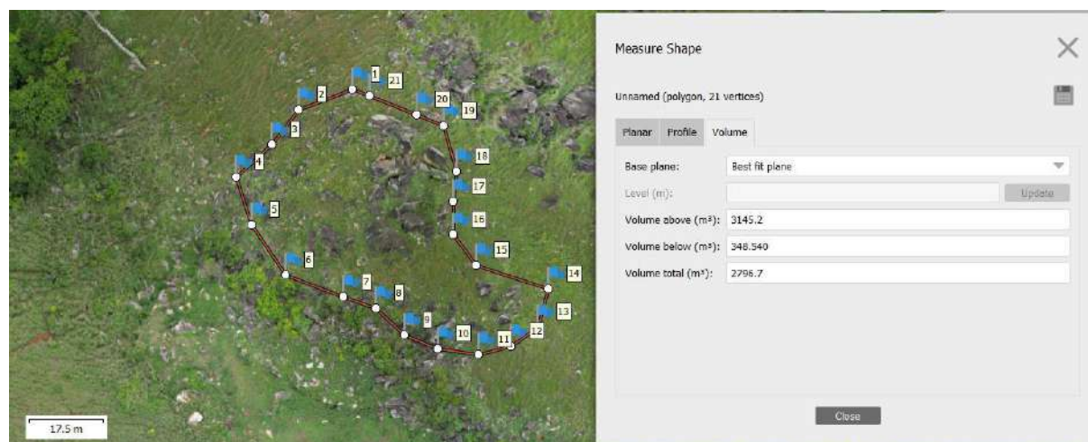
Figura 44- Volume de quase 3000m 3 que necessita de fixação.
