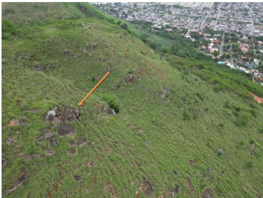
Figura 26- Área a ser fixada por conta do risco a rolamento de blocos advindos do afloramento
