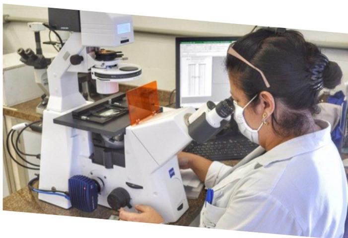
O Laboratório de Qualidade da Água da Estação de Tratamento de Água (ETA) do Guandu ganhou um moderno equipamento: o microscópio Axio Observer 5, referência na geração de imagens em alta resolução. O novo microscópio tem filtros específicos capazes de apurar o contraste, o que facilita a identificação de micro-organismos, com destaque para as cianobactérias.
