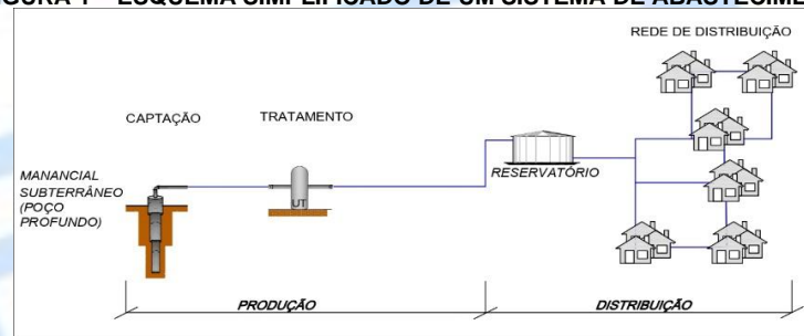
FIGURA 1 – ESQUEMA SIMPLIFICADO DE UM SISTEMA DE ABASTECIMENTO
