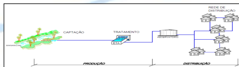
FIGURA 1 – ESQUEMA SIMPLIFICADO DE UM SISTEMA DE ABASTECIMENTO
