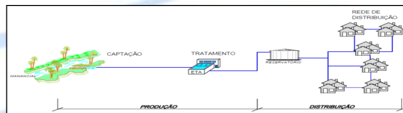
FIGURA 1 – ESQUEMA SIMPLIFICADO DE UM SISTEMA DE ABASTECIMENTO
