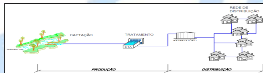
FIGURA 1 – ESQUEMA SIMPLIFICADO DE UM SISTEMA DE ABASTECIMENTO
