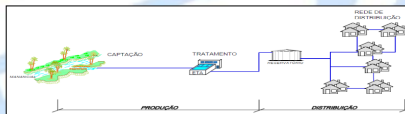
FIGURA 1 – ESQUEMA SIMPLIFICADO DE UM SISTEMA DE ABASTECIMENTO
