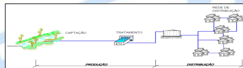
FIGURA 1 – ESQUEMA SIMPLIFICADO DE UM SISTEMA DE ABASTECIMENTO
