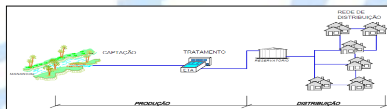
FIGURA 1 – ESQUEMA SIMPLIFICADO DE UM SISTEMA DE ABASTECIMENTO
