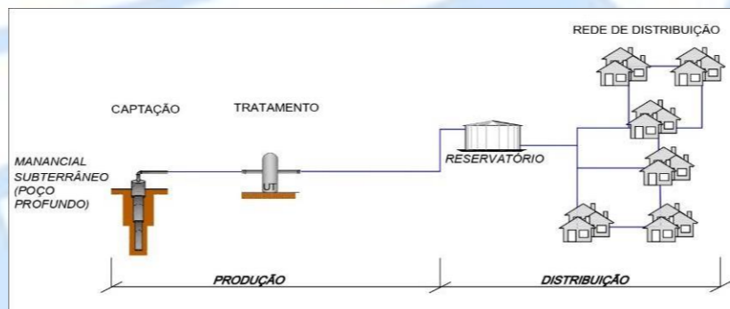
FIGURA 1 – ESQUEMA SIMPLIFICADO DE UM SISTEMA DE ABASTECIMENTO
