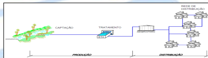
FIGURA 1 – ESQUEMA SIMPLIFICADO DE UM SISTEMA DE ABASTECIMENTO
