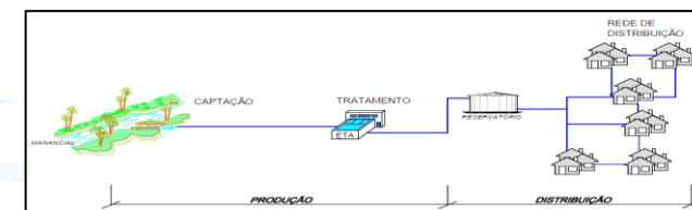
FIGURA 1 - ESQUEMA SIMPLIFICADO DE UM SISTEMA DE ABASTECIMENTO
