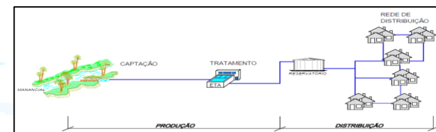
FIGURA 1 – ESQUEMA SIMPLIFICADO DE UM SISTEMA DE ABASTECIMENTO
