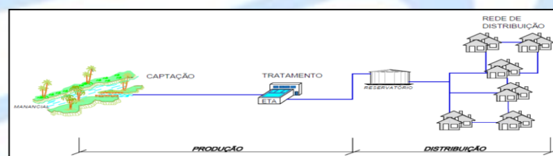
FIGURA 1 – ESQUEMA SIMPLIFICADO DE UM SISTEMA DE ABASTECIMENTO
