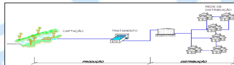
FIGURA 1 – ESQUEMA SIMPLIFICADO DE UM SISTEMA DE ABASTECIMENTO
