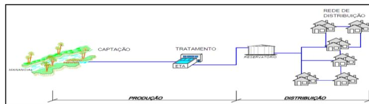
FIGURA 1 – ESQUEMA SIMPLIFICADO DE UM SISTEMA DE ABASTECIMENTO
