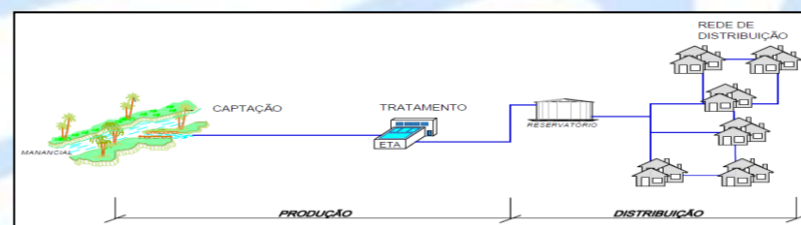
FIGURA 1 – ESQUEMA SIMPLIFICADO DE UM SISTEMA DE ABASTECIMENTO
