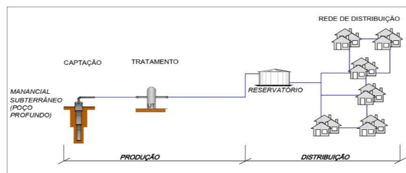
FIGURA 1 – ESQUEMA SIMPLIFICADO DE UM SISTEMA DE ABASTECIMENTO
