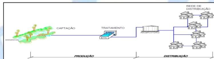
**FIGURA 1 – ESQUEMA SIMPLIFICADO DE UM SISTEMA DE ABASTECIMENTO**
