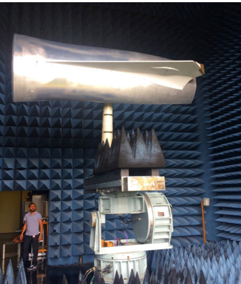
Figura 02: Protótipo de antena dorsal de aeronave testada em câmara anecóica
