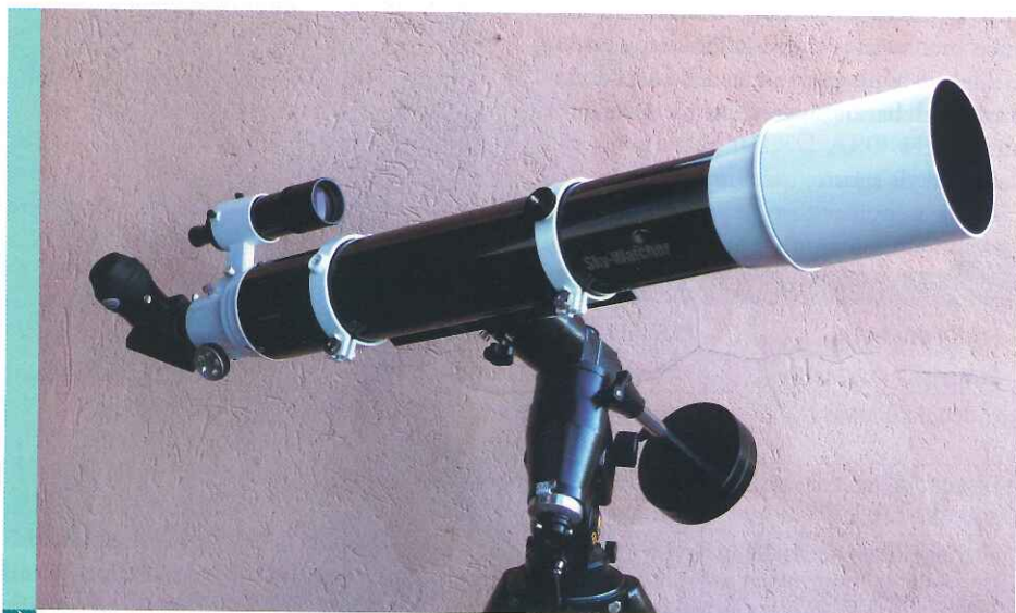
Abbiamo montato lo Sky-Watcher su una EQ5, che lo regge bene. Anche in considerazione del prezzo di questa ottica, diremmo che è la "sua" montatura.
