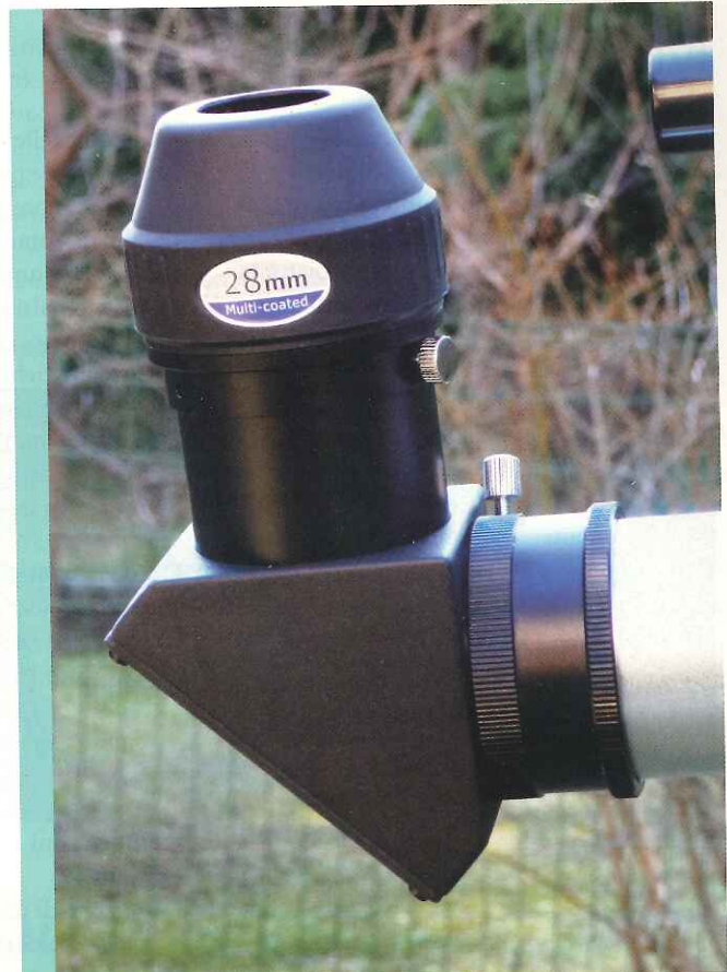
▶ Il prisma a 90° e l'oculare da 28 mm in dotazione, entrambi con barilotti da 2".
