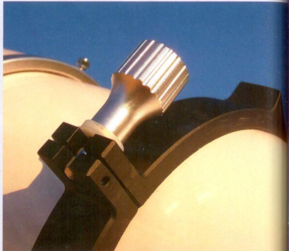
Un acierto dotar a este telescopio de una cola de milano ancha tipo Losmandy, además de dos abrazaderas robustas, bien diseñadas, basculantes y cómodas.
