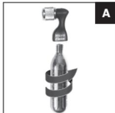
2. **GONFLAGE DES PNEUS AVEC LE MICROFLATE** : visser et dévisser la cartouche de CO2 dans le Microflate contrôle le débit du gaz. Pour faire venir le débit du gaz, tournez la cartouche dans le sens contraire des aiguilles d'une montre pour la dévisser légèrement. Pas plus d'un demi-tour. Pour arrêter l'arrivée du gaz dans le pneu, tournez la cartouche dans le sens des aiguilles d'une montre afin de la serrer contre la tête. Gonflez le pneu à la pression souhaitée.
