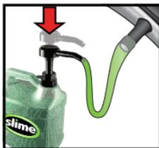
**5** Conecte la manguera e inyecte el Slime.\*
