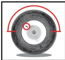
**1** Coloque el centro de la válvula en la mitad superior de la llanta.
