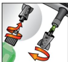
**2** Extraiga lentamente el núcleo de la válvula con la herramienta del tapón.
