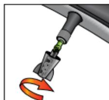
**6** Vuelva a colocar el núcleo de la válvula.
