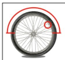
**1** Posicione la válvula en la mitad superior del neumático.
