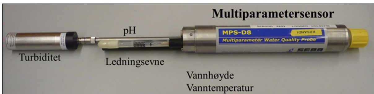
Figur 2.9. Multiparametersensor for automatisk overvåking av vannkvalitet.
