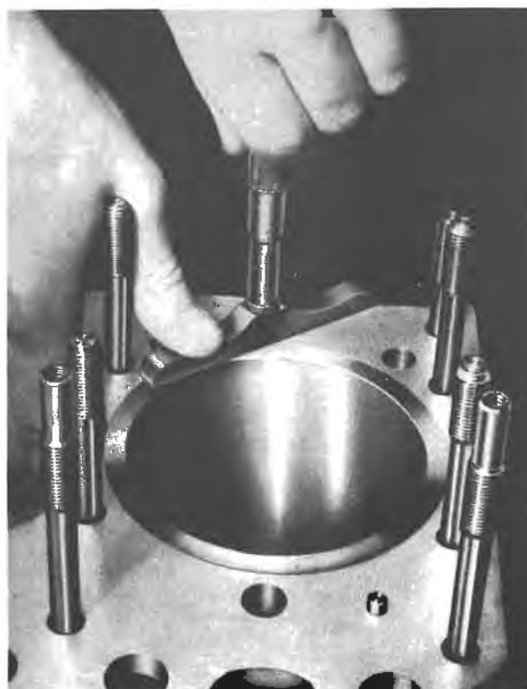
Fig. E17 Checking cylinder liner 'nip'
