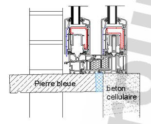
Une base plane et stable doit toujours être prévue pour les fenêtres coulissantes!
