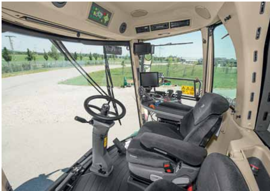
De Visio5-cabine is ontworpen voor optimaal zicht en biedt een perfecte ergonomie en bediening op de werkplek. Dankzij de speciaal gevormde dakcontour kan de bestuurder de uitwerpklep goed in het zicht houden. Een aangenaam arbeidsklimaat wordt gegarandeerd door de automatische airconditioning en verwarming.
