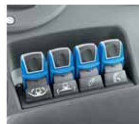
Via tuimelschakelaars kunt u gemakkelijk functies bedienen zoals maïsvoorzetstuk en pick-upsteunwielen in-uitklappen, hellingvoorzetstuk, uitwerpbuchten heffen-neerlaten.
