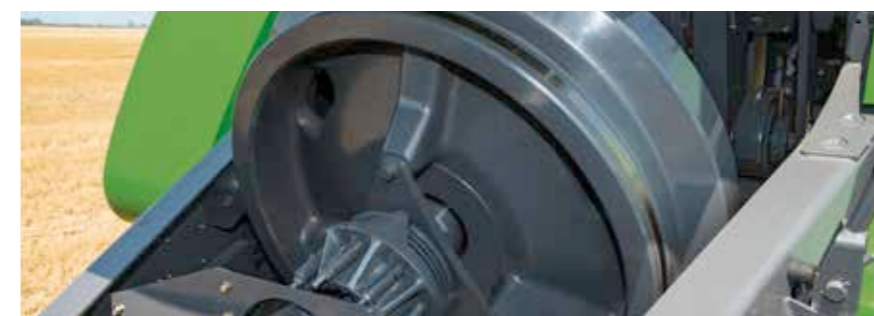
Het zware vliegwiel van 545 kg zorgt ervoor dat de pers rustig en gelijkmatig loopt, terwijl de krachtoverbrenging tegelijkertijd bijzonder hoog is.
