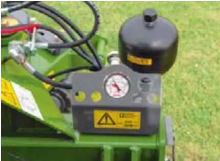
De hydropneumatische maaibalkontlasting TurboLift maakt de unieke ‘zwevende snede’ mogelijk.
