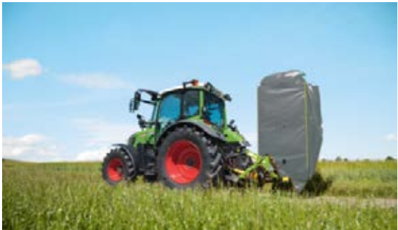
Vanuit de cabine gemakkelijk te veranderen van werkstand in de zeer compacte transportstand.
