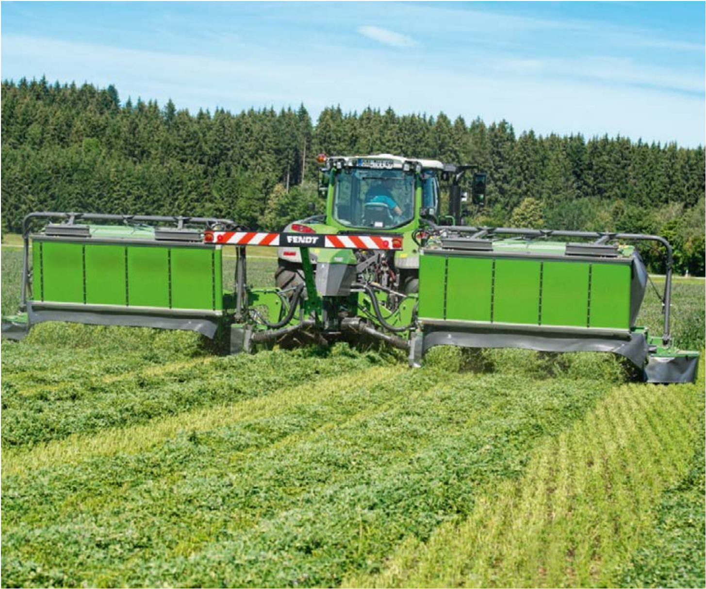
Met een druk op de knop klapt u de banden naar boven legt u het gewas over de totale breedte af.
