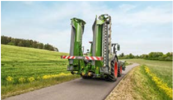
In opgeklapte toestand is de hoogte van de maaiercombinatie nog steeds minder dan 4 meter. Ook zorgt het lage zwaartepunt voor een comfortabel weggedrag.
