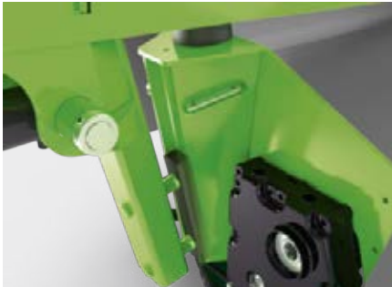
De gepatenteerde glijgeleiding zorgt voor optimale geleiding en stabiliteit van de maaibalk.
