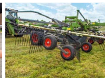
Bij het laten zakken op de kopakker raken eerst de achterste wielen de grond, daarna de voorste. Bij het uitheffen gaan de voorste rotoren het eerst omhoog. Dankzij dit zgn. jet-effect wordt de zode ontzien.
