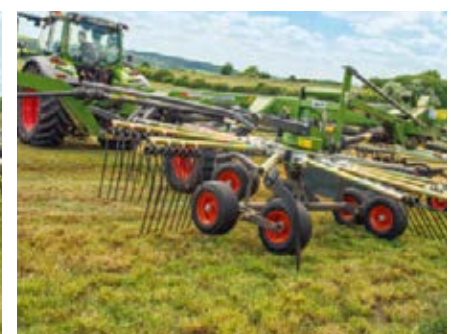
Bij het laten zakken op de kopakker raken eerst de achterste wielen de grond, daarna de voorste. Bij het uitheffen gaan de voorste rotoren het eerst omhoog. Dankzij dit zgn. jet-effect wordt de zode ontzien.
