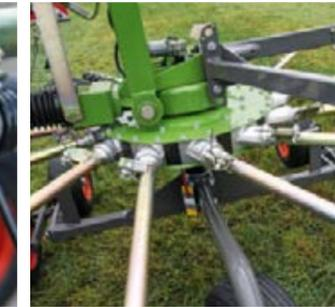
La transmission se compose d'un seul engrenage conique avec arbre de pignon conique divisé à roulements à paliers doubles.
