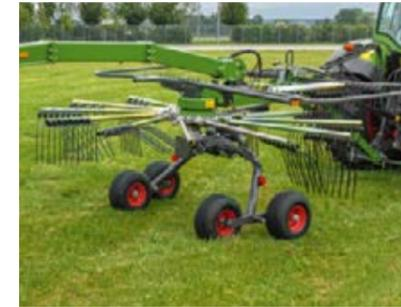
L'inclinaison horizontale des toupies peut être facilement ajustée en desserrant le boulon de serrage et en tournant simplement les boulons des cames.
