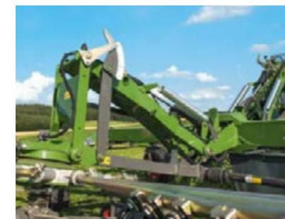
En utilisant le réglage hydraulique de la largeur de travail, il est possible d'obtenir aisément la largeur souhaitée sans quitter la cabine du tracteur. L'indicateur facile à lire donne des informations sur la largeur de travail réglée.
