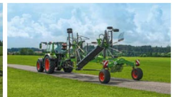
Le contrôle de séquences soulève toujours la toupie de l'andaineur Fendt Former dans la bonne séquence en bout de champ. Les andaineurs à dépose latérale à deux toupies Fendt Former sont également rapides et fiables sur route et peuvent être repliés pour former une unité compacte.
