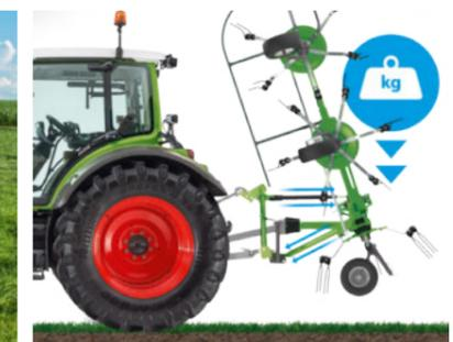
D'excellents résultats peuvent également être obtenus sur les contours du champ grâce au dispositif d'éparpillage en bordure, autour duquel pivote l'ensemble de la faneuse.
