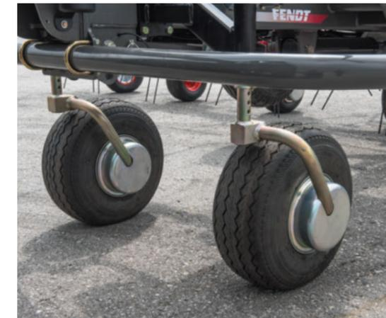
□ Les roues d'appui mobiles en option optimisent le suivi du terrain et garantissent un ratisage propre et une protection de l'herbe. (Fendt Twister 901 T)
