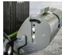
□ Un lest supplémentaire de 1996 kg peut être monté sur le châssis avant.
