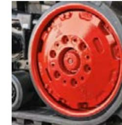
La suspension pendulaire des galets garantit un suivi parfait du contour du sol et un contact constant avec le terrain.
