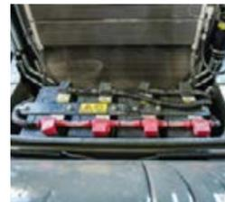
■ Quatre batteries sans entretien fournissent l'alimentation nécessaire au Fendt 1100 MT.
