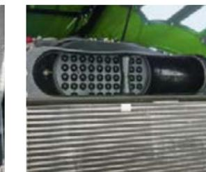
Grâce au filtre à air avec séparateur de poussière, l'air d'admission est propre et frais.
