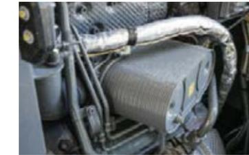
Le gros intercooler sert de deuxième étage de refroidissement, ce qui permet de refroidir de manière significative l'air d'admission et d'optimiser ainsi la combustion.
