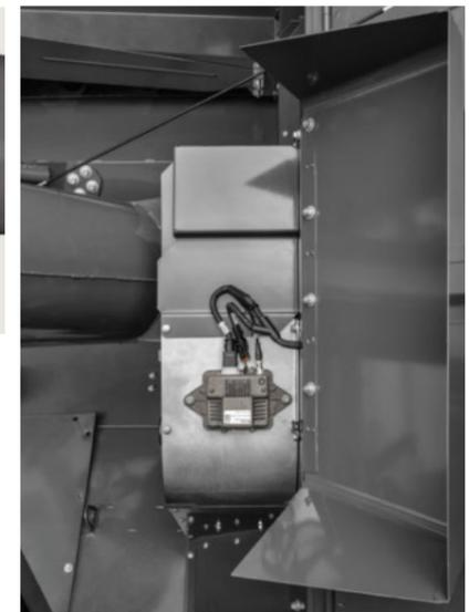
Le rendement, l'humidité et la qualité sont toujours parfaitement représentés grâce aux données en provenance directe du champ : des capteurs de rendement et d'humidité, ainsi qu'une caméra surveillant la qualité du grain sont montés sur l'élévateur. Les données sont précises à 98 % près, et peuvent être exploitées grâce au VarioDoc ISOBUS, la cartographie de rendement et IDEALharvest™.
