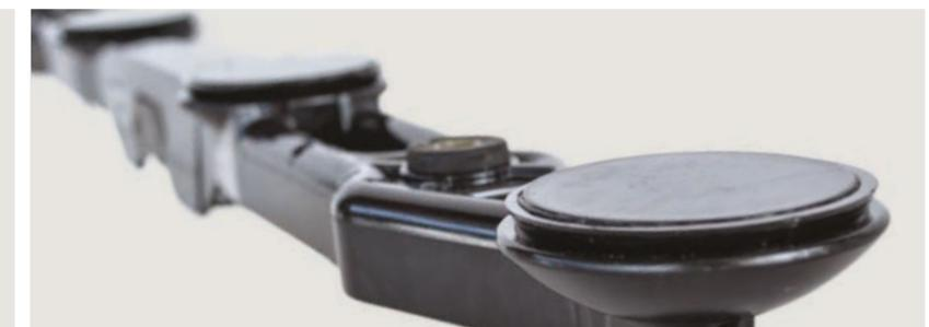
Les capteurs de pertes installés à l'extrémité du caisson aident le conducteur à régler la machine sur la meilleure configuration possible, en signalant les pertes de céréales au sol par une impulsion et une alarme sonore.
