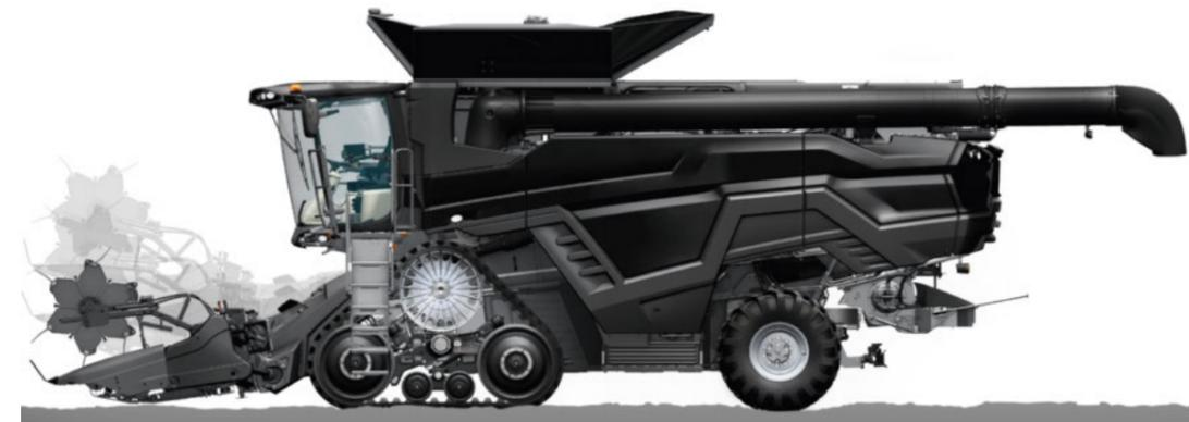
La hauteur des rabatteurs peut être réglée automatiquement, en combinaison avec toutes les fonctions de la barre de coupe, pour un ramassage parfait des céréales.
