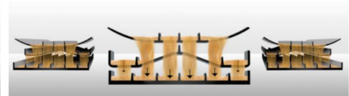
La table de préparation du grain avant est concave, afin d'acheminer le produit vers le centre de la table. La table de préparation du grain arrière est convexe et achemine le produit vers l'extérieur.
