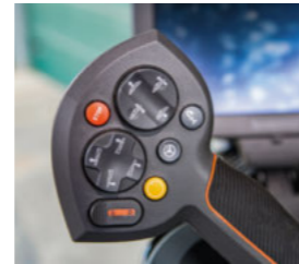
■ Joystick multifonctions OptiControl, optimisé pour la protection des cultures.
