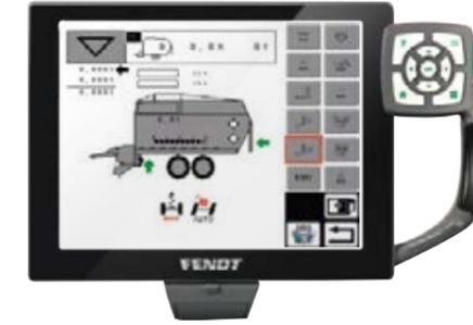
Vous trouverez aisément la position optimale du timon pour la vidange avec le système de déchargement automatique. Réglez individuellement la vitesse du fond mouvant.
