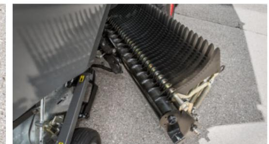
Le système centralisé de déverrouillage des couteaux permet de remplacer les couteaux un à un, rapidement et facilement.
