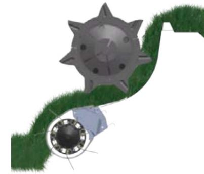
La vitesse périphérique synchronisée permet au pick-up de tourner moins vite avec une très bonne reprise du rotor.
