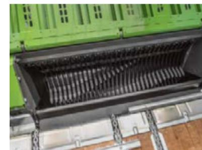
Le rotor de 800 mm de diamètre et à six rangées de dents en spirale en acier Hardox est équipé des deux côtés de roulements à rouleaux sphériques.
