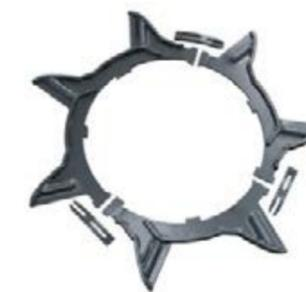
Les dents du rotor se composent de trois éléments et peuvent être retirées séparément. Trois nouveaux éléments sont verrouillés, pour pouvoir les remplacer facilement, puis soudés trois fois avec des butées individuelles.
