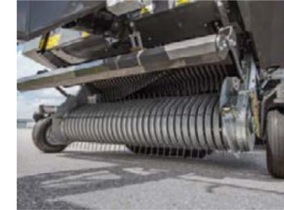
Les roues de jauge pivotantes du pick-up permettent de ramasser proprement dans les angles et protègent ainsi le tapis végétal. Réglez la hauteur des roues avec une série de trous.
