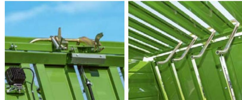
Grâce au système de chargement automatique 2 positions, une légère pression est exercée sur un peigne, tandis qu'une pression modérée est mesurée via le hayon de chargement.
