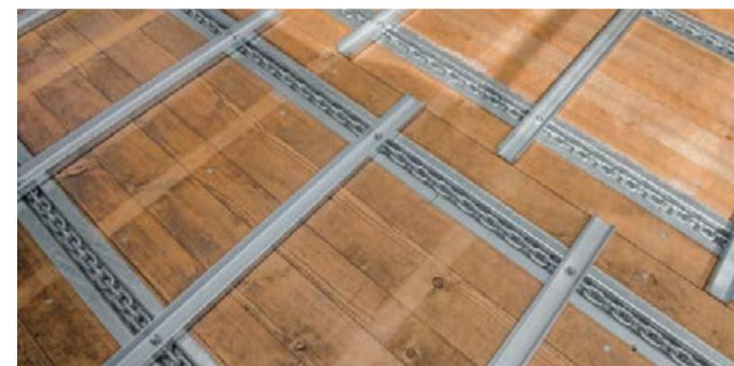
Grâce aux quatre chaînes en acier rondes et de 10 mm d'épaisseur des grands modèles Tigo MS, MR et MR Profi avec une charge de rupture de 50 tonnes, vous êtes prêts, y compris pour les applications les plus rudes. Les petits modèles Tigo MS et MR vous accompagnent avec deux chaînes du fond mouvant et une charge de rupture de 25 tonnes. En option, vous pouvez également équiper les plus petits modèles de quatre chaînes et barrettes.
