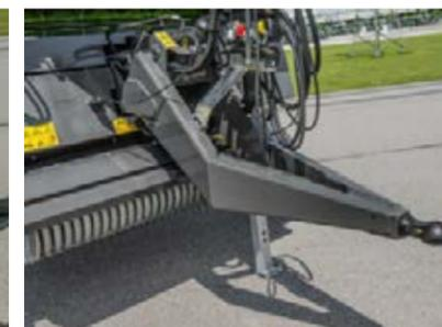
Les modèles Fendt Tigo peuvent être équipés en option d'un attelage inférieur avec une boule d'attelage K 80.
