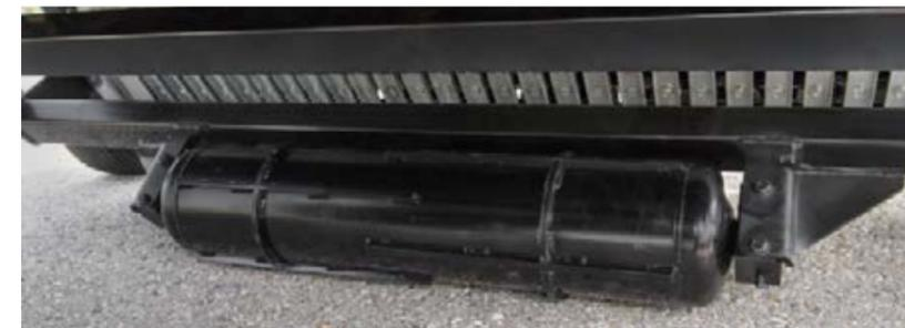
Le rouleau palpeur installé au centre du pick-up, derrière celui-ci, maintient en permanence la hauteur de ramassage définie et garantit un guidage sûr du pick-up, même sur terrains accidentés. Il en résulte une excellente qualité de fourrage car les saletés restent sur le sol.
