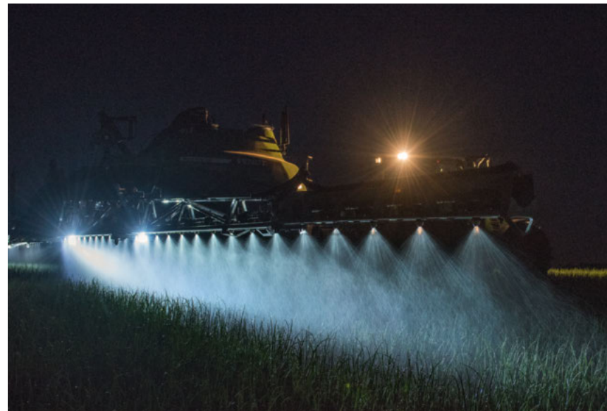
■ Led-werklampen voor optimaal zicht op de spuitsecties. Als optie zijn ook 2 of 4 blauwe led-werklampen leverbaar. De werklampen zijn als bescherming tegen afzettingen vóór de doppen gemonteerd.
