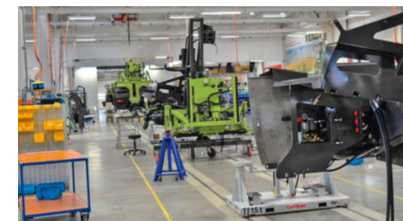
Onze nieuwe, uiterst moderne productielijn voor veldspuiten bij Fendt in Hohenmölsen (D)
