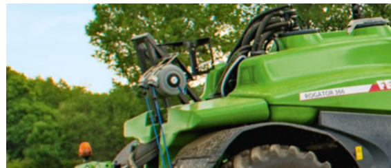
□ Met de praktische slanghaspel achter aan de veldspuit is reinigen snel en gemakkelijk.
