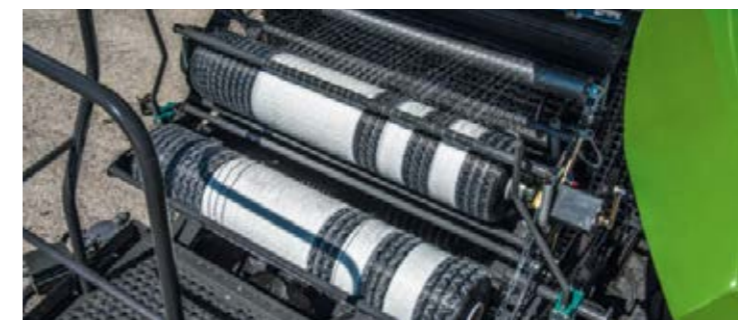
Le système EasyLoad permet de charger des rouleaux de rechange en un moins de temps qu'il ne faut pour le dire.
