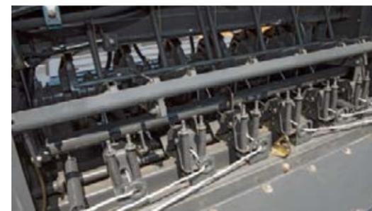
La ficelle est guidée par les freins du nœud, pour un chargement homogène de la ficelle dans le nœud.
