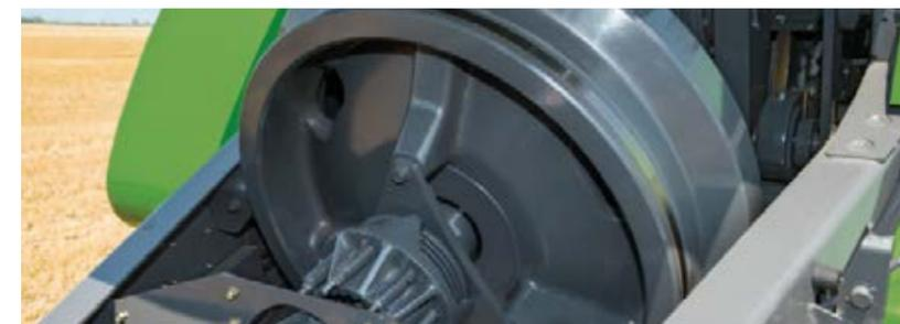
Le volant d'inertie de 545 kg assure un fonctionnement homogène et régulier, mais aussi un transfert de puissance élevé.
