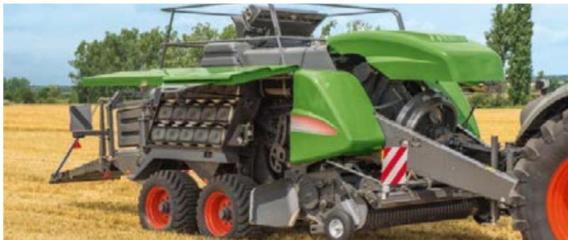
La facilité d'entretien était au centre des préoccupations pendant la conception des presses à balles carrées Fendt. Les panneaux latéraux qui s'ouvrent largement et les roulements étanches graissés réduisent considérablement le temps nécessaire à la maintenance.
