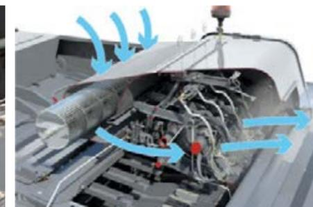
Le système de ventilation transversal fait partie de l'équipement standard, il permet de maintenir un flux d'air constant sur toute la zone des nœuds permettant ainsi un parfait nettoyage de ces derniers.
