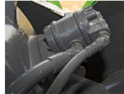
Les volets de la chambre de pressage sont contrôlés automatiquement par les vérins hydrauliques à double effet dans le canal de compression.
