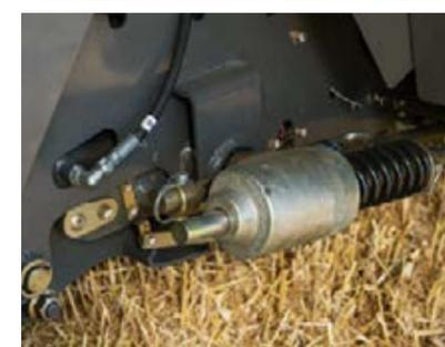
Le réglage de la hauteur se fait sans aucun outil, tout simplement en levant le pick-up et en insérant une tige dans l'orifice voulu.
