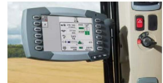
Le terminal couleur C1000 est installé de série. Si le tracteur n'est pas compatible ISOBUS ou si l'opérateur souhaite utiliser un terminal séparé, il est possible de se rabattre sur le C1000 à tout moment.
