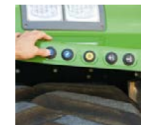
Actionnez le relevage arrière, la PDF et un distributeur confortablement depuis les garde-boue arrière.
