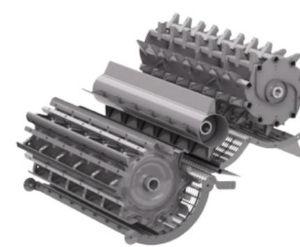
Le contre-séparateur est entièrement au-dessus du séparateur Multi-Crop. Cette position est principalement recommandée pour les récoltes dont le battage est aisé et dans des conditions sèches.
