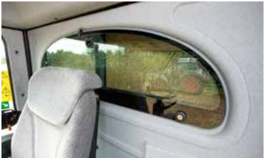
Blik van de bestuurderszitplaats in de graantank
