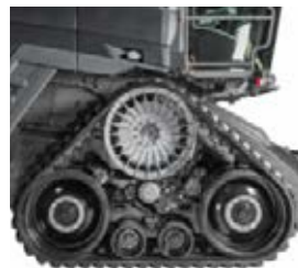
Het TrakRide-rupsonderstel zorgt voor minimale bodemdruk.
